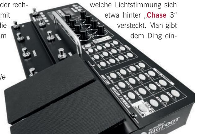
*Erst bei Betätigung der „Go“-Taste (links unten am Gerät) wird der vorgewählte Effekt tatsächlich ausgelöst.*
